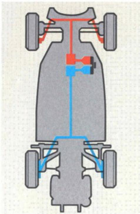
Er hat überdimensional große Bremsen, die durch eine Zweikreis-Bremsanlage besonders betriebssicher sind:
