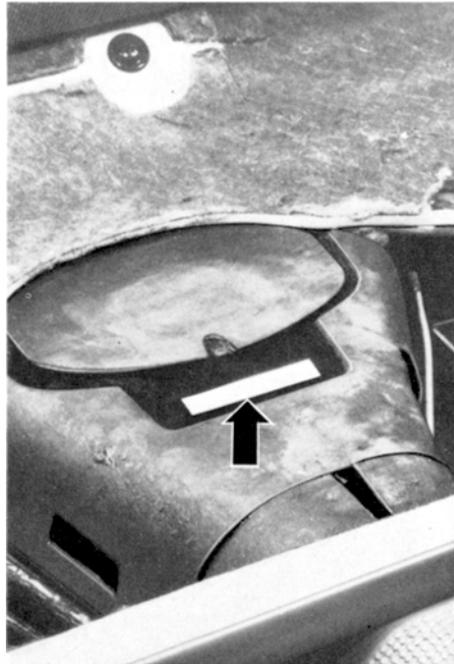
**Die Motornummer** steht am Flansch des Kurbelgehäuses für den Generatorträger.
