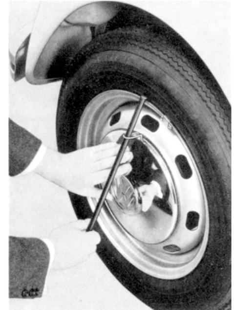
Betätigungsstange in das obere Hebelgelenk (A) des Wagenhebers einstecken und Wagen anheben.
