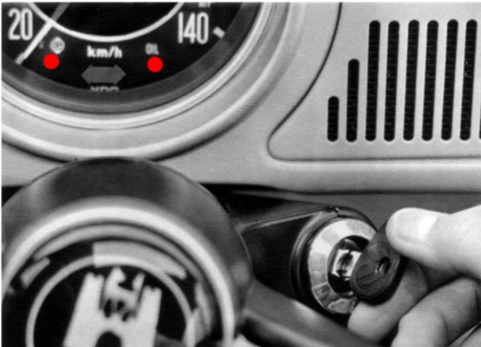
Wenn die Zündung eingeschaltet ist, leuchten im Tachometer zwei rote Kontrolllampen auf.
