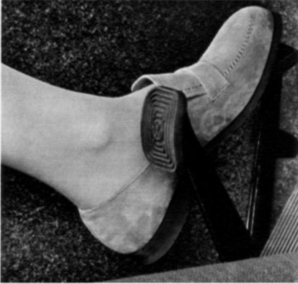
Damit Motor und Räder getrennt bleiben, treten Sie das Kupplungspedal ganz durch.
