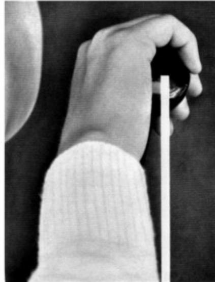
Man führt den Gangschalthebel geradewegs nach **hinten** bis zum Anschlag.
