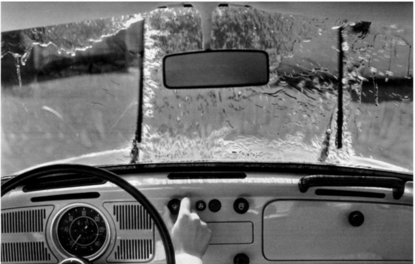
Zum Einschalten der Scheibenwischer drehen Sie den Drehschalter am Instrumentenbrett nach rechts.
