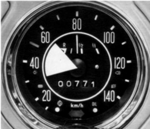
Mit dem dritten Gang fahren Sie Geschwindigkeiten bis zu 60 km/h.
