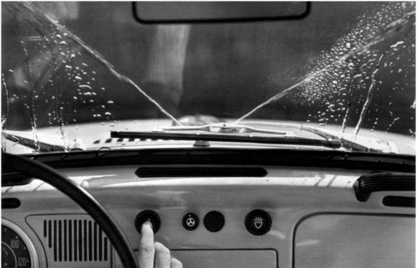
Drücken Sie auf die Mitte des Drehschalters, arbeitet die Scheibenwaschanlage.
