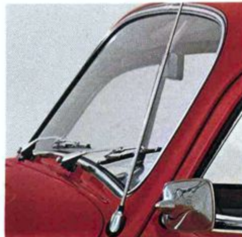
52. Versenkantenne , Teleskop aus Edelstahl, verschließbar.
