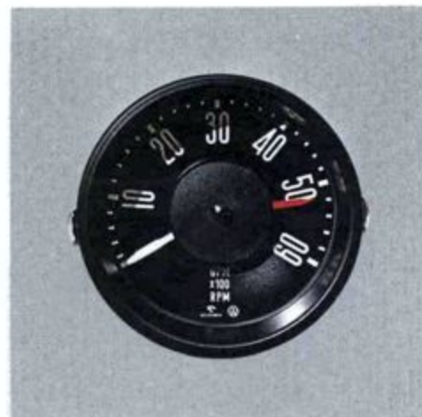
21. Drehzahlmesser, Meßbereich bis 6.000 U/min, 85 mm Durchmesser, komplett mit Anschlußleitungen zum Einbau anstelle der Zeituhr in Typ 3-Fahrzeugen.
