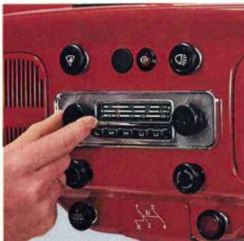
46. Autoradio „Braunschweig“ , UKW, Mittel- und Langwelle, 12 Volt *. Senderschnellwahl durch Stationsdrucktasten: 2 x UKW, 2 x MW, 1 x LW. Mit Anschlußbuchse für Autoradio-Tonbandgerät.
