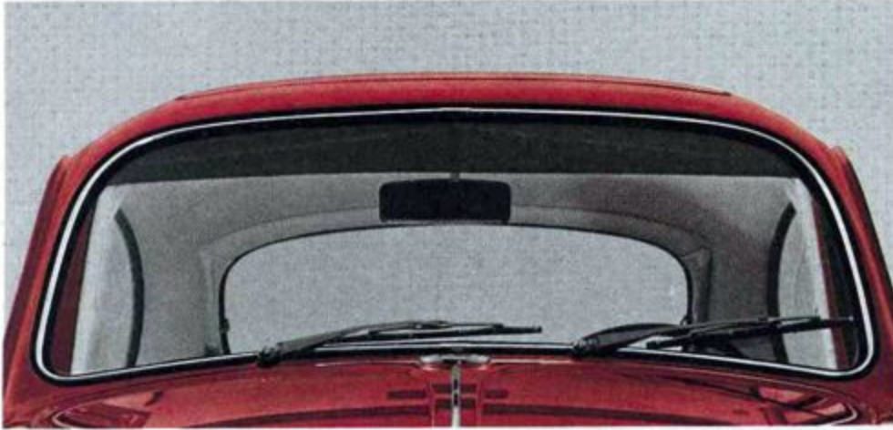
59. Blendschutz an der Windschutzscheibe , aus grün eingefärbtem Kunststoff, selbstklebend.
