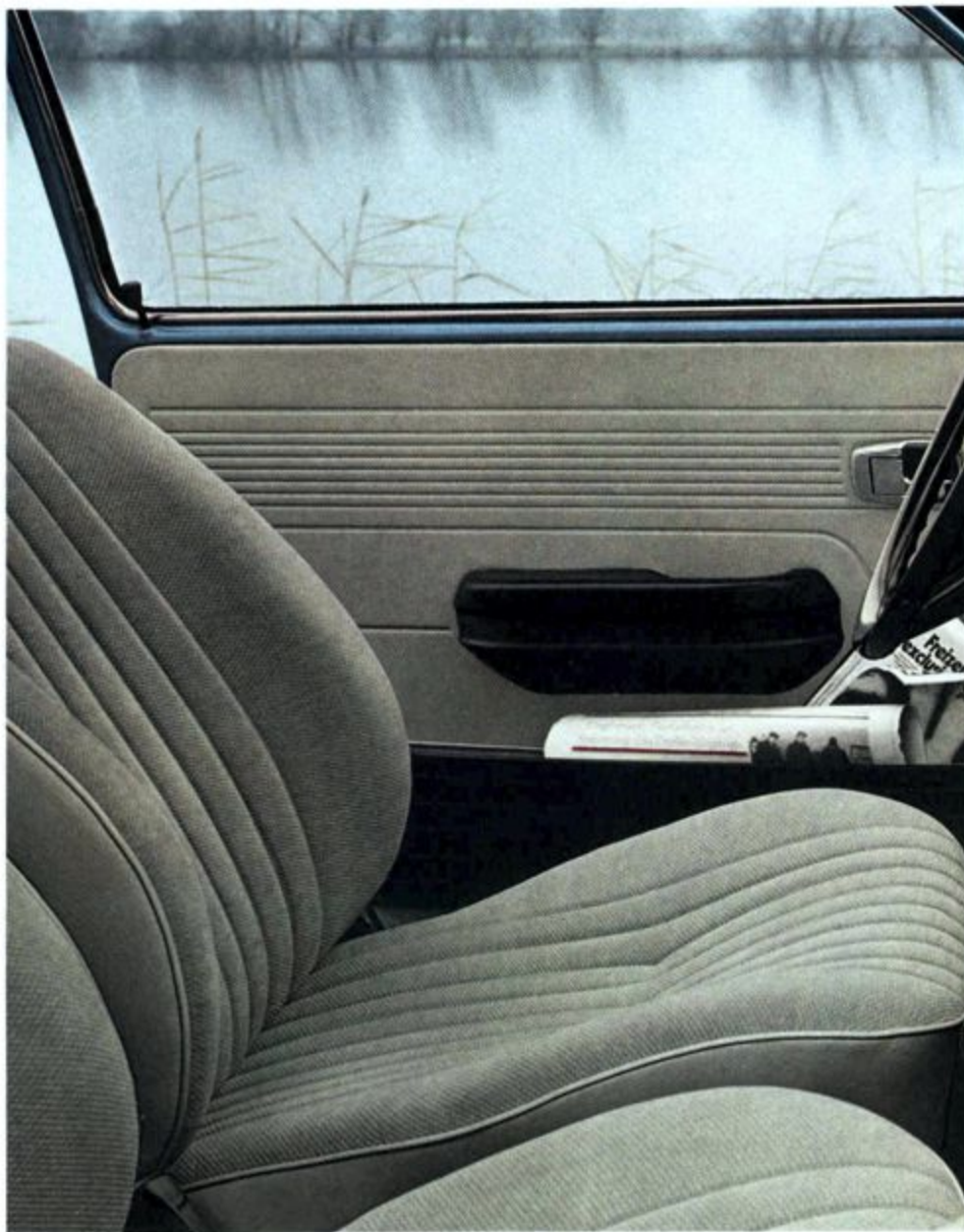
26. Liegesitzbeschlag , für Vordersitz, stufenlos verstellbar. Nach Entriegelung richtet sich die Lehne automatisch auf. 27. Rückenstütze , verstellbar, unsichtbarer Einbau in die Rückenlehne.
