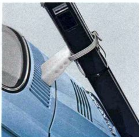
42. Heckskihalter , aus bruchfestem, witterungsbeständigem Kunststoff. Auch für Skier mit Fersenautomatik verwendbar.
