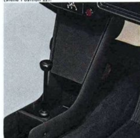
22. Instrumententafel mit Ablage, mit genarbttem Schaumstoff überzogen. Vorbereitet für den Einbau verschiedener Instrumente, Schalter und Steckdosen.
