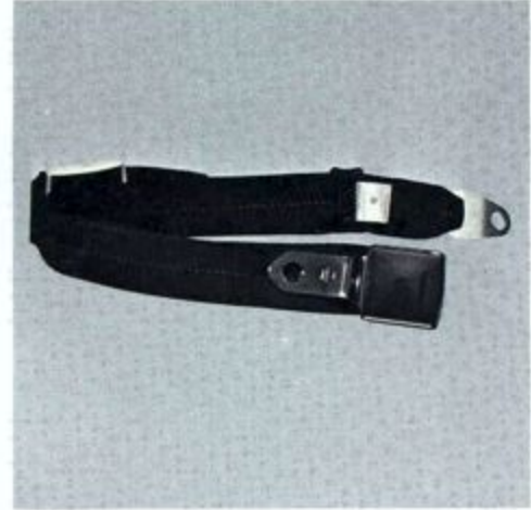
68. Sicherheitsgurt , Dreipunktbefestigung, schnelles und einfaches Öffnen.
