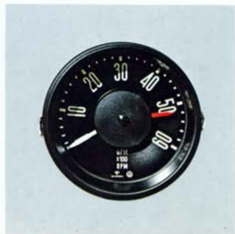
26. Drehzahlmesser, Meßbereich bis 6.000 U/min, 85 mm Durchmesser, komplett mit Anschlußleitungen zum Einbau anstelle der Zeituhr in Typ 3-Fahrzeugen.
