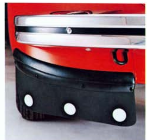
77. Schmutzfänger, aus verschleißfestem Gummi, schwarz mit weißen Punkten. 1 Satz = 2 Stück.
