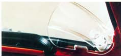
69. Sonnenschutzblende, verstellbar, aus Kunstglas, rauchgrau. Anbau an der Regenrinne.
