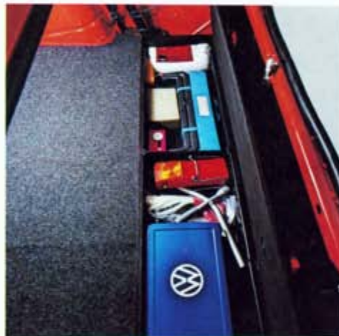
39. Gerätebox für Kofferraum, aus schwarz durchgefärbtem Polystrol.
