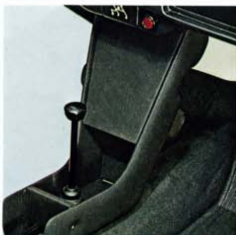
25. Instrumententafel mit Ablage, mit genarbttem Schaumstoff überzogen. Vorbereitet für den Einbau verschiedener Instrumente, Schalter und Steckdosen.
