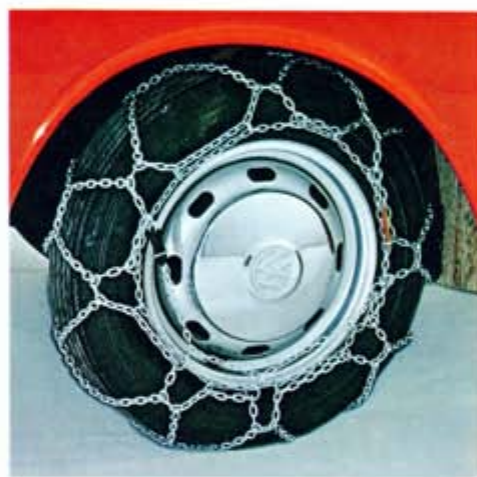
73. Schneeketten, Kantenspur, schnell zu montieren. 1 Stück.
