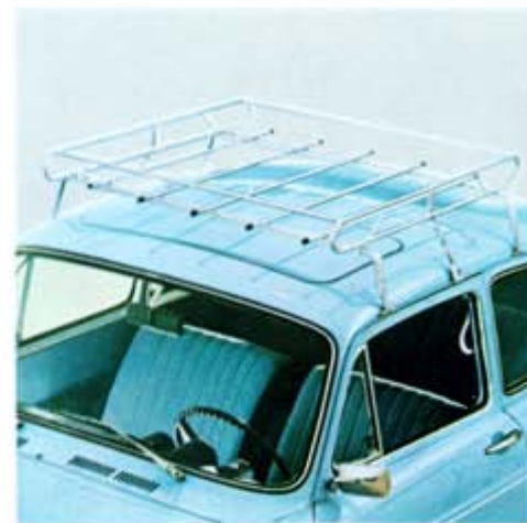
44. Dachgepäckträger , je nach Fahrzeug-Typ unterschiedliche Größen und Ausführungen.
