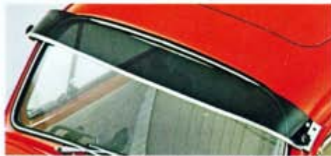
68. Windabweiser für Stahlkurbeldach, aus Kunstglas, glasklar oder rauchgrau.
