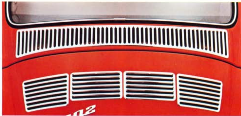
8. Heckziergitter, aus Aluminium, chromglanz-eloxiert, einteilig.
