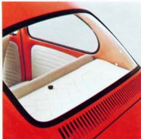
37. Kofferraumabdeckung, mit beiderseitiger Schaumgummi-Auflage, Kunstleder-überzug und gesteppter Schachtklappe.
