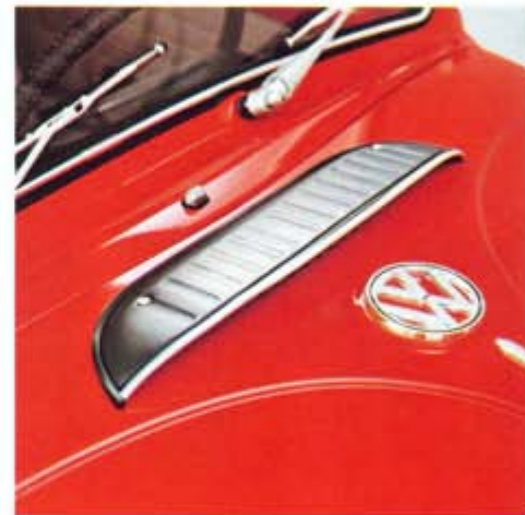
2. Haube für Belüftungsschlitze, aus Aluminium.
