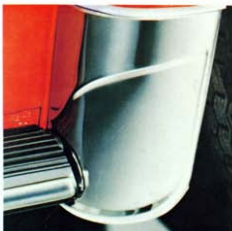
11. Kotflügelschutzecken, chromglanz-eloxiert. Ein Satz für zwei hintere Kotflügel.
