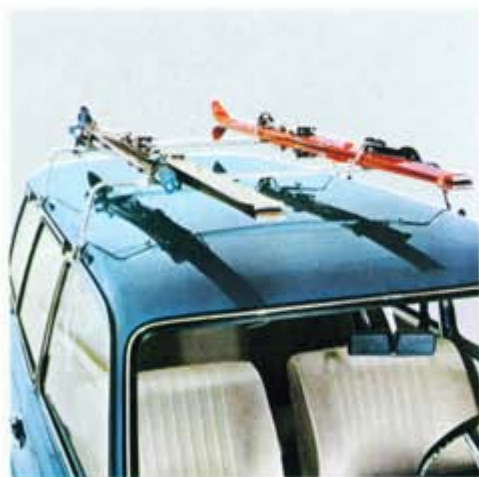
49. Dachskihalter , für 4 Paar Skier oder 2 Paar Wasserskier geeignet.
