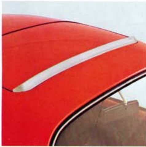
67. Windabweiser für Stahlkurbeldach, aus Aluminium, chromglanz-eloxiert.
