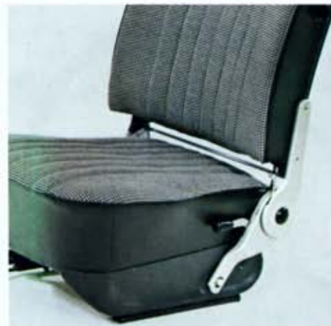
31. Liegesitzbeschlag , für Vordersitz, stufenlos verstellbar. Nach Entriegelung richtet sich die Lehne automatisch auf.
