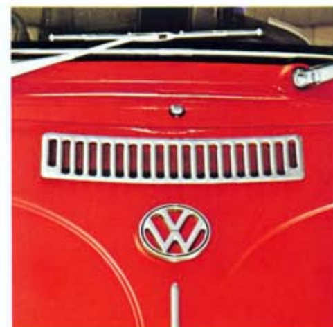
3. Frontziergitter, aus Aluminium, chromglanz-eloziert, einteilig. Für VW-Transporter zweiteilig.
