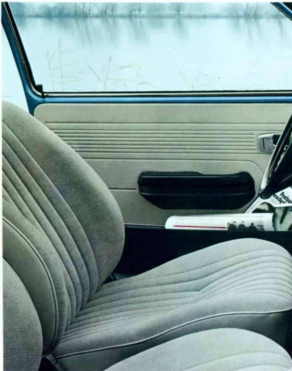
31. Liegesitzbeschlag , für Vordersitz, stufenlos verstellbar. Nach Entriegelung richtet sich die Lehne automatisch auf.
