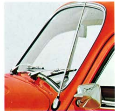
59. Versenkantenne , Teleskop aus Edelstahl, verschließbar.
