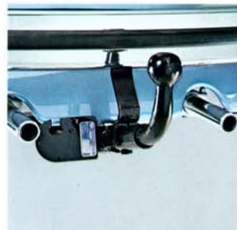
47. Anhängervorrichtung , verschiedene Ausführungen, zulässige Anhängelast richtet sich nach dem Fahrzeug-Typ.
