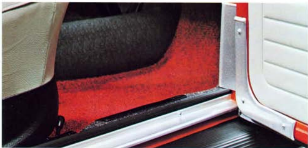
5. Einstiegleisten, aus Aluminium, fein gerieft, 1 Satz = 2 Stück.
